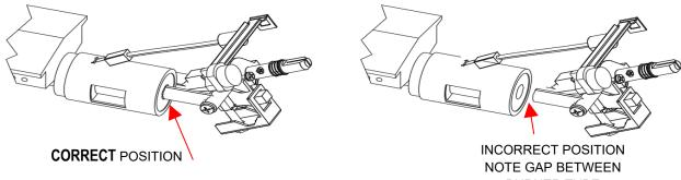
BURNER TUBE AND BURNER ORIFICE
